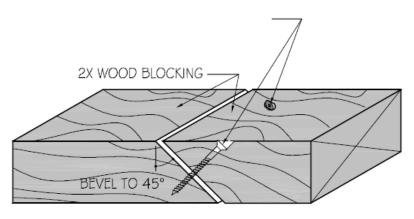
FIGURE 6 - MITERED WOOD JOINT DETAIL
