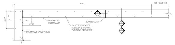
FIGURE 3A - WOOD BLOCKING CORNER ANCHORAGE 8'-0" FROM CORNER
