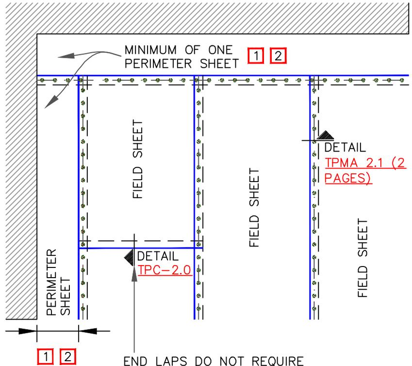
END LAPS DO NOT REQUIRE MECHANICAL ATTACHMENT AND SHALL BE OVERLAPPED 2" (5cm) MINIMUM. PER [DETAIL TPC-2.0](#)
