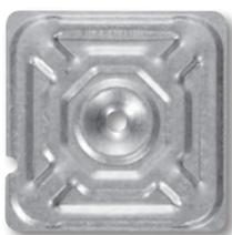
Las placas AccuTrac son placas cuadradas con fondo plano o de bajo relieve de 3 pulg. fabricadas de acero revestido Galvalume. Se usan para sujetar aislamientos con la herramienta AccuTrac.
