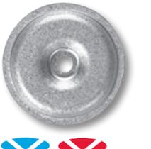
Una placa metálica de 2 pulg. de diámetro, aplicable con fijaciones HPV, MP 14-10 y CD-10, utilizada para la fijación del aislamiento en Sistemas MF o la fijación de la membrana en cambios de ángulo en Sistemas Adheridos junto con la fijación Versico adecuada.
