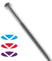
Un sujetador especialmente diseñado con una punta de perforación de ½ pulg. que se utiliza para fijar las membranas VersiGard, VersiWeld y VersiFlex a correas de acero estructural (hasta ¾ pulg.) en aplicaciones de reacondicionamiento de techos metálicos de junta de plegado saliente.
