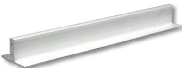
Este perfil es extruido del mismo compuesto TPO o PVC resistente al clima que la membrana. El perfil acanalado se fija a la membrana de techo de TPO o PVC para simular un sistema de techado metálico con junta de plegado saliente. La estabilidad dimensional física de los perfiles se mejora con fibra de vidrio y el perfil rectangular proporciona líneas de sombra excepcionales para mejorar la estética.
