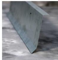
El listón para faja a presión SureTite de Versico es un listón continuo de Galvalume calibre 22 que está disponible en longitudes de 12 pies. Este producto cuenta con orificios previamente perforados para sujetadores espaciados 12 pulg. entre centros. El listón de borde de goteo puede usarse con el metal del borde cuando se usan láminas planas de metal Versico para fabricar la cubierta en el taller.
