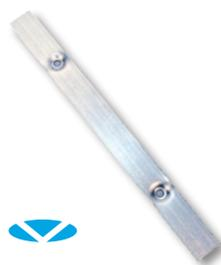
Barra de metal con revestimiento Galvalume™ que se usa para la sujeción mecánica de las membranas EPDM. La barra se puede cortar con facilidad a la longitud deseada. Se instala con sujetadores HPV.
