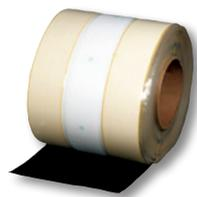
Se utiliza RUSS de 10 pulg. (ver imagen) para sistemas con sujeción mecánica en lugar de láminas angostas, para asegurar la membrana en el perímetro del techo. También hay disponible RUSS de 6 pulg. y se usa para fijar más la membrana en la base de las paredes verticales, sin penetrar la lámina.
