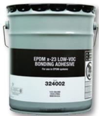
Pegamento de contacto con base de solvente y alta resistencia que permite la unión de membranas EPDM a diversos sustratos porosos y no porosos. Este producto cumple con los requisitos de contenido de COV <250 g/l de la Reglamentación Modelo de la OTC sobre adhesivos para sistemas de techado en una sola capa. Tasa de cobertura: 60 pies cuadrados de superficie terminada por galón.
