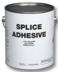
Diseñado para empalmar membranas EPDM curadas y cubrejuntas sin aplicación rápida, este cemento de contacto con base de solvente y alta resistencia permite la adhesión rápida de cubrejuntas, láminas y costuras de goma curada. Formulado para aplicar con un rodillo de felpa mediano de 1/2 pulg. y/o pincel de pintura de 1/2 pulg. de espesor, el tiempo de adhesión de gran versatilidad permite revestir y adherir grandes áreas de una sola vez.
