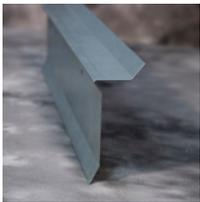
El listón para faja a presión SureTite de Versico es un listón continuo de Galvalume calibre 22 que está disponible en longitudes de 12 pies. Este producto cuenta con orificios previamente perforados para sujetadores espaciados 12 pulg. entre centros. El listón para faja a presión puede usarse con el metal del borde cuando se usan láminas planas de metal Versico para fabricar la cubierta en el taller.
