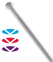
Sujetador de diámetro n.º 14 utilizado para la fijación de las membranas VersiGard reforzada, VersiWeld y VersiFlex en cubiertas de hormigón estructural (mínimo 3,000 psi). Se usa también para fijar aislamientos en pisos de techo de acero, madera y hormigón.
