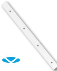
Una barra de polímero diseñada que se utiliza para conectar mecánicamente las membranas EPDM. Esta barra viene con orificios centrados pretaladrados cada 3 pulg. La tira se puede cortar con facilidad a la longitud deseada. Instale la tira utilizando fijaciones HPV o HPVX
