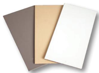
Lámina de acero galvanizada de calibre 24 (0.6 mm) revestida con una capa de cubrejunta no reforzado de 0.035 pulg. La membrana se puede soldar directamente sobre el metal revestido. La lámina está cortada al ancho adecuado y se usa para fabricar bordes de goteo metálicos u otros perfiles de borde perimetral de techo.
