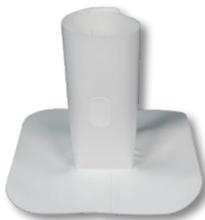
Fabricado usando la membrana para detalles de VersiWeld y la membrana de VersiFlex™ y diseñado para recubrir tuberías metálicas cuadradas. Se incorpora en estas piezas una lengüeta de superposición y dividida para permitir que los cubrejuntas se abran y se plieguen sobre una penetración cuadrada con una obstrucción. Medidas y colores adicionales a disposición por pedido especial.
