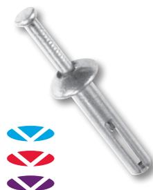
Se usa con la barra de terminación o con las placas de sujeción de costuras de Versico para fijar membranas a bloques de hormigón o paredes estructurales de hormigón o ladrillo. El perno de acero revestido de zinc brinda excelente resistencia a la corrosión y el cuerpo de aleación de zinc tiene un poder de retención excelente.
