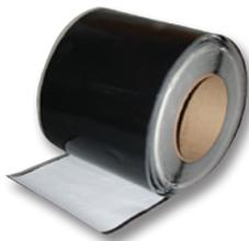
EPDM sin curar laminado sobre adhesivo de goma sintético. El cubrejunta de aplicación rápida se puede usar para recubrir esquinas, tuberías y otras penetraciones.
