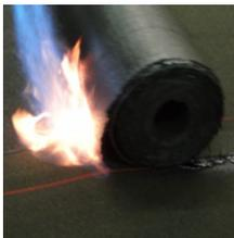
Membranas SBS premium de superficie lisa aplicadas con soplete y reforzadas con lámina de fibra de vidrio. Puede utilizarse como capa base en sistemas multicapa, como barrera de aire y vapor, o como cubierta temporal hasta 60 días. Excelente para aplicaciones de baja temperatura cuando no es posible utilizar membranas despegables. Los sustratos ideales incluyen hormigón imprimado y SECUROCK imprimado.
