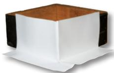
Cubrejuntas fabricados, hechos con membrana para detalles VersiWeld y membrana VersiFlex, diseñados para disminuir el tiempo de cobertura del bordillo. Cada esquina tiene una base con pestaña de 6 pulg. de ancho y una altura total de 12 pulg. Un bordillo requiere 4 esquinas. Otras medidas y colores a disposición por pedido especial. También se pueden pedir envolturas de 1 o 2 piezas.
