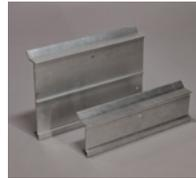
El listón extruido para faja de Versico es un listón continuo de aluminio extruido de 0.080 pulg. que está disponible en longitudes de 12 pulg. Este producto cuenta con orificios previamente perforados para sujetadores espaciados a 12 pulg. entre centros y puede usarse con metal de borde fabricado en taller cuando se usan láminas planas de metal Versico para fabricar la cubierta.
