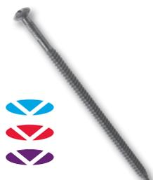
Un sujetador de diámetro n.º 15 para usar con acero, madera y madera contrachapada CDX. Se puede utilizar para asegurar las membranas VersiGard, VersiWeld y VersiFlex.
