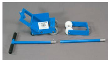
El aplicador de cinta cobertora APEEL está hecho de aluminio de servicio pesado con revestimiento pulverizado y sujetadores de acero inoxidable. Contiene un rollo de cinta cobertora APEEL y utiliza ruedas de presión segmentadas por tamaño para garantizar una adherencia adecuada.
