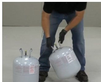
Agitation des réservoirs côté A et côté B
