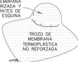
COLOCAR Y SOLDAR POR CALOR LAS ESQUINAS EN SU LUGAR COMO MUESTRA LA FIGURA
