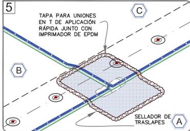
APLIQUE RECUBRIMIENTO PARA UNIONES EN T VERSICO DE APLICACIÓN RÁPIDA O UN TROZO DE CUBREJUNTAS DE EPDM SIN CURAR DE APLICACIÓN RÁPIDA DE 6 PULGADAS (152 mm) DE ANCHO CENTRADO SOBRE EL PUNTO DE INTERSECCIÓN DE LOS BORDES ANTERIORES DE LA INTERSECCIÓN DEL EMPALME DE CAMPO, COMO MUESTRA LA FIGURA.
