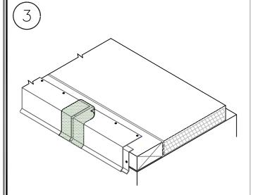
HEAT WELD 6" (15cm) WIDE PIECE OF NON-REINFORCED MEMBRANE OVER THE JOINT.
