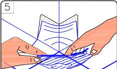
ROLL & CREASE FLASHING TIGHTLY INTO ANGLE CHANGE & FIRMLY ROLL FLASHING ONTO THE DECK MEMBRANE
