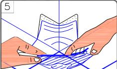
ROLL & CREASE FLASHING TIGHTLY INTO ANGLE CHANGE & FIRMLY ROLL FLASHING ONTO THE DECK MEMBRANE
