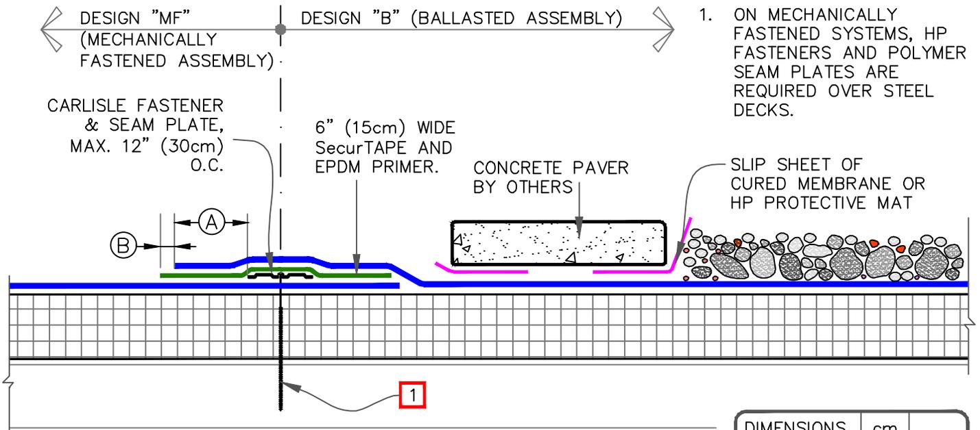
**(B) BALLASTED TO MECHANICALLY FASTENED TIE-IN**
