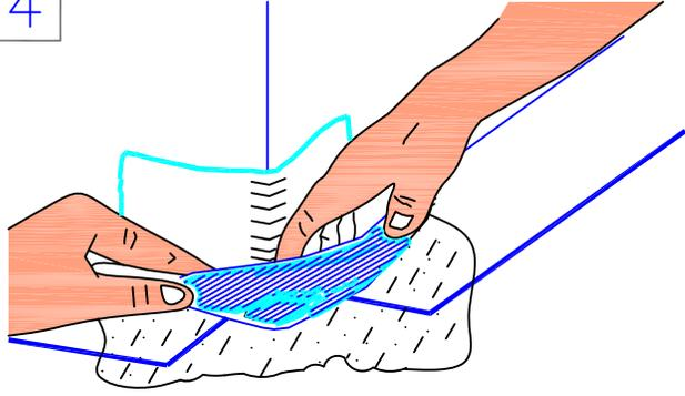
PLACE FOLDED FLASHING TIGHTLY INTO ANGLE CHANGE AND FIRMLY PRESS FLASHING ONTO THE DECK FLANGE BY PRESSING THE FLASHING AGAINST THE HORIZONTAL SURFACE.
