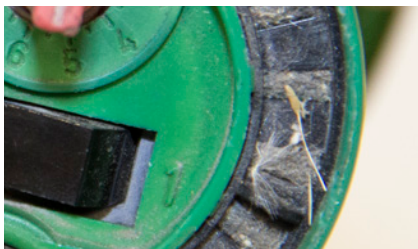
Suciedad y residuos en la toma de aire
