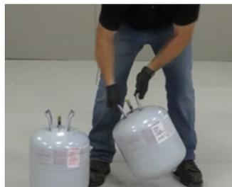
Agite los tanques del lado A y del lado B.
