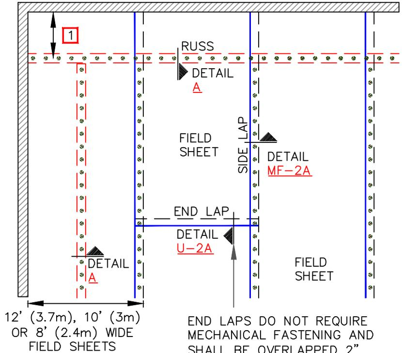
END LAPS DO NOT REQUIRE MECHANICAL FASTENING AND SHALL BE OVERLAPPED 2" (5cm) MINIMUM. SEE [DETAIL U-2A](#)
