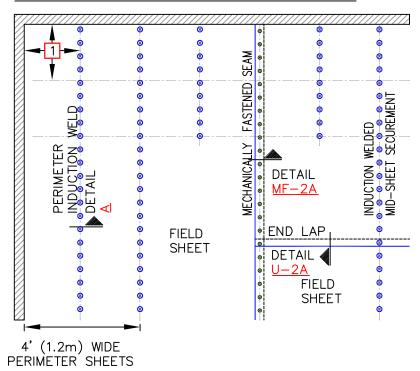
HYBRID INDUCTION WELD/MECHANICALLY-FASTENED ASSEMBLY - 16' WIDTH TPO ROLLS ONLY
