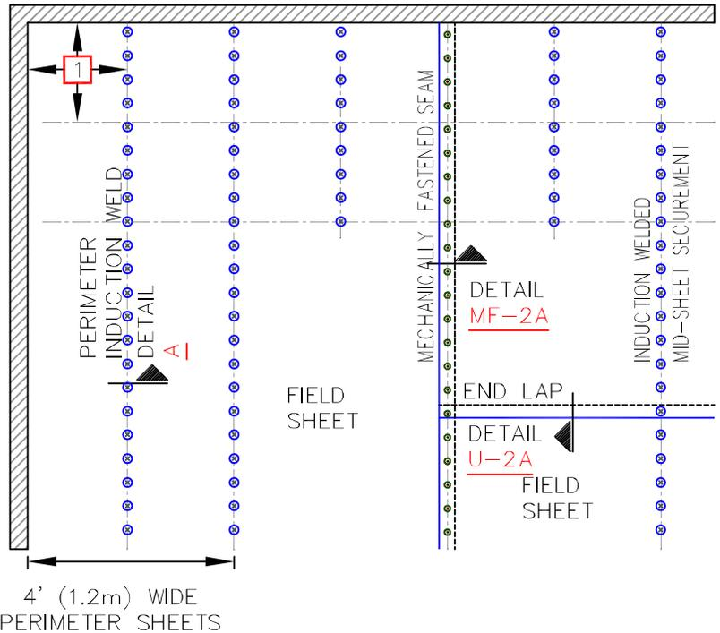
**HYBRID INDUCTION WELD/MECHANICALLY-FASTENED ASSEMBLY - 16' WIDTH TPO ROLLS ONLY**
