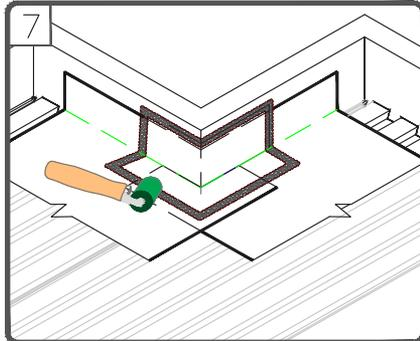
PLACE FOLDED FLASHING TIGHTLY INTO ANGLE CHANGE AND FIRMLY PRESS FLASHING ONTO THE DECK FLANGE BY PRESSING THE FLASHING AGAINST THE HORIZONTAL SURFACE.
