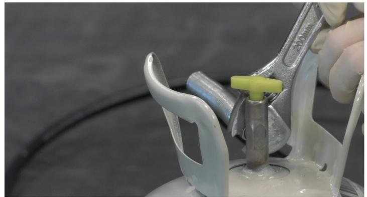
**Paso 4:** Conecte la manguera al cilindro de UN-TACK con una llave de boca o una llave inglesa. Una vez que esté bien sujeta, cierre la válvula ubicada en la parte superior del cilindro de UN-TACK.
