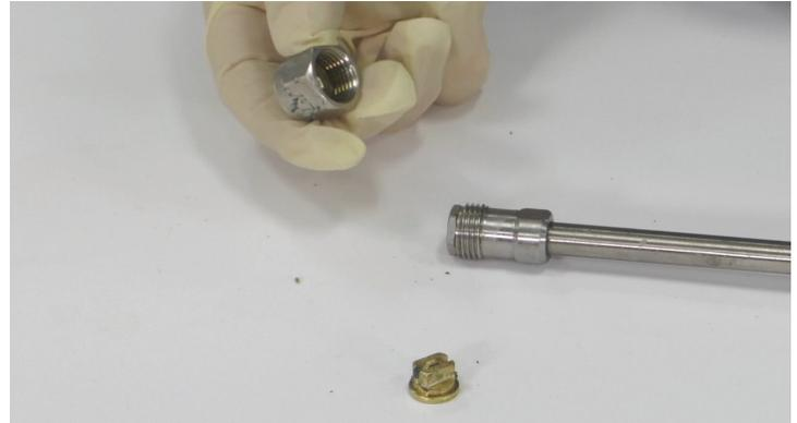
**Paso 3:** Coloque una nueva punta de aspersión o una punta de aspersión limpia en la tapa de retención. Haga girar la tapa de retención sobre el conjunto de extensión roscado.
