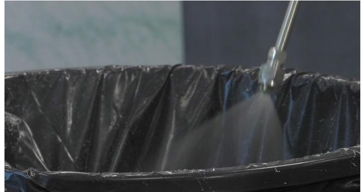
**Paso 6:** Alivie la presión en la manguera disparando la pistola dentro del bote de basura. Retire cualquier resto de adhesivo que pueda haber quedado en la punta de aspersión. Desconecte la manguera del cilindro de UN-TACK. Ahora la pistola y la manguera se pueden almacenar. Le sugerimos que proteja el extremo de la manguera para evitar la entrada de contaminantes.
