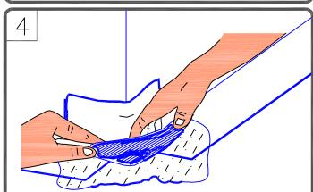
PLACE FOLDED FLASHING TIGHTLY INTO ANGLE CHANGE AND FIRMLY PRESS FLASHING ONTO THE DECK FLANGE BY PRESSING THE FLASHING AGAINST THE HORIZONTAL SURFACE.
