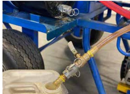
9. Coloque el lado B de la manguera en el recipiente de ISO Flush.
