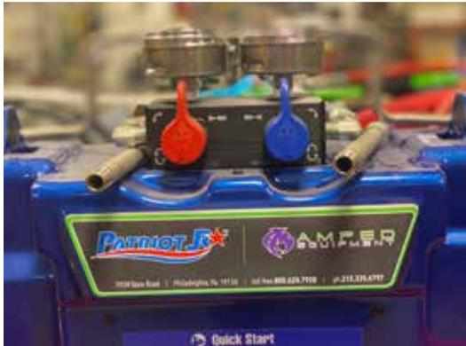
6. Abra completamente las dos válvulas de fluido desde los tambores. Debe observar que los materiales del lado A y B llenan el tubo transparente antes del siguiente paso.
