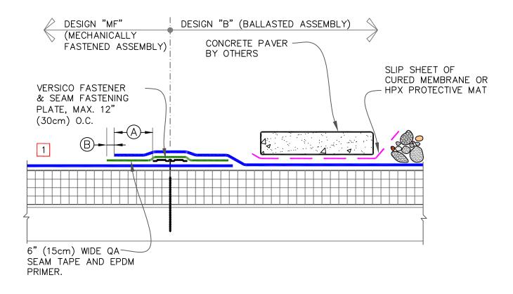
1. ON MECHANICALLY ATTACHED SYSTEMS, HPX FASTENERS AND POLYMER SEAM PLATES ARE REQUIRED OVER STEEL DECKS.
