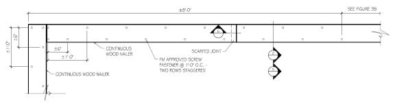
FIGURE 3A - WOOD BLOCKING CORNER ANCHORAGE 8'-0" FROM CORNER
