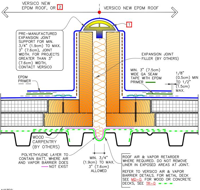
1. MEMBRANE FLASHING SHALL <u>NOT</u> BE ADHERED OVER THE EXPANSION JOINT SUPPORT.
