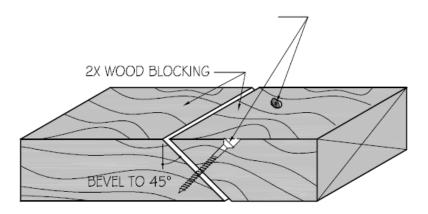
FIGURE 6 - MITERED WOOD JOINT DETAIL
