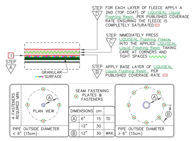
TABLE FOR FASTENER REQUIREMENTS ON MECHANICALLY FASTENED SYSTEMS. REFER TO CARLISLE TYPICAL PENETRATION DETAILS FOR FLASHING OVER FASTENER HEADS.
