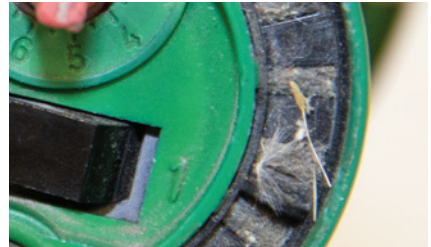
Suciedad y residuos en la toma de aire
