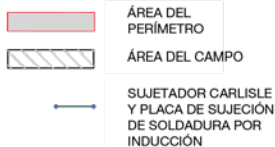
(B) CAMPO DEL TECHO 6 SUJETADORES POR PLACA DE 4 FT X 8 FT
