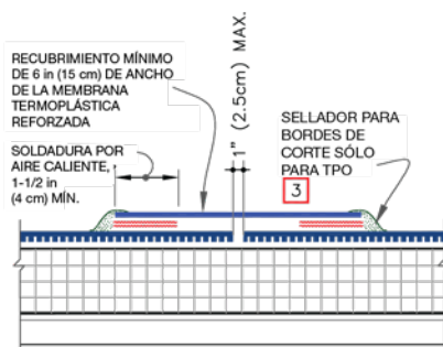
EMPALME DE TRASLAPE FINAL
