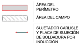
B CAMPO DEL TECHO 6 SUJETADORES POR PLACA DE 4 ft X 8 ft
