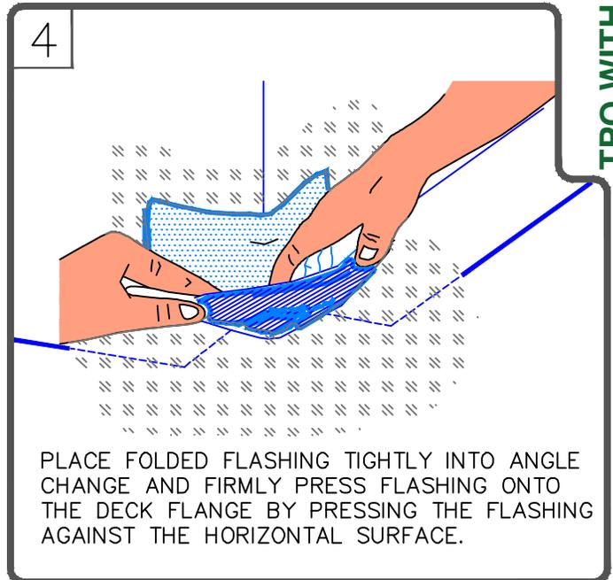
PLACE FOLDED FLASHING TIGHTLY INTO ANGLE CHANGE AND FIRMLY PRESS FLASHING ONTO THE DECK FLANGE BY PRESSING THE FLASHING AGAINST THE HORIZONTAL SURFACE.
