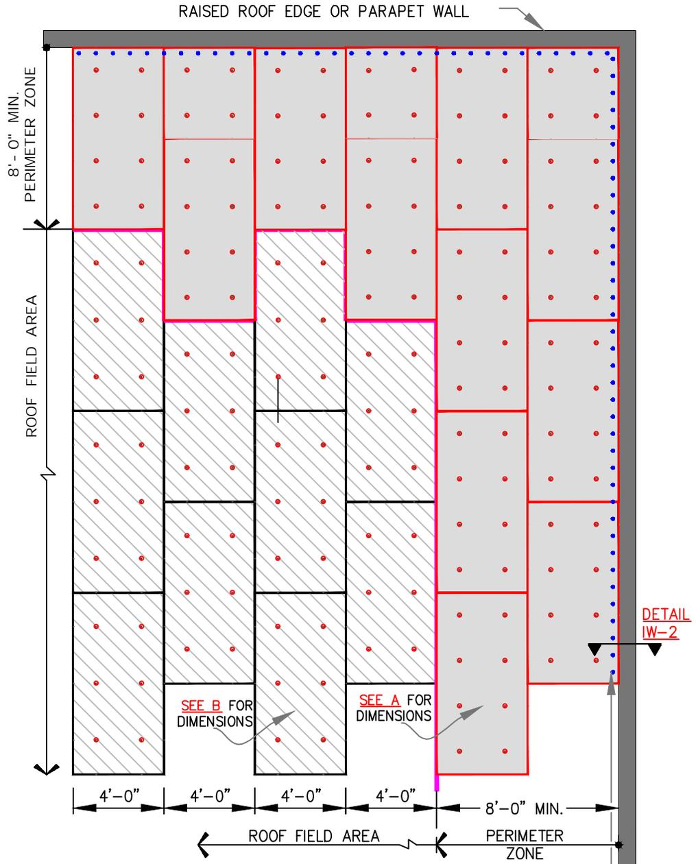
MEMBRANE FASTENED MINIMUM 12" O.C. AT ANGLE(S) CHANGES.
