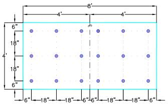
16 FASTENERS PER 4'X8' BOARD 18 FASTENERS PER 4'X8' BOARD
