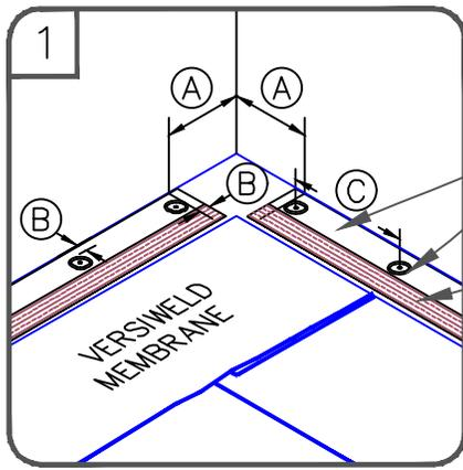
6" (15cm) WIDE PRESSURE-SENSITIVE RUSS (REINFORCED UNIVERSAL SECUREMENT STRIP)
