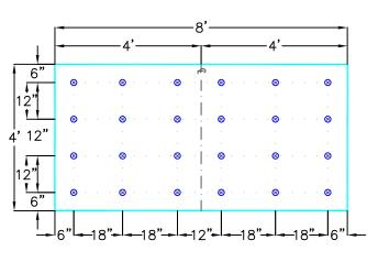
20 FASTENERS PER 4'X8' BOARD 24 FASTENERS PER 4'X8' BOARD
