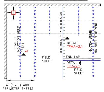
HYBRID INDUCTION WELD/MECHANICALLY-ATTACHED ASSEMBLY - 16' WIDTH TPO ROLLS ONLY
