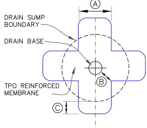
CUT SECTION OF TPO REINFORCED MEMBRANE AS SHOWN AND POSITION INTO DRAIN SUMP. EXTEND MEMBRANE OUT OF DRAIN SUMP APPROXIMATELY 6" (15cm) (ROUND CORNERS).i
