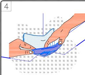
PLACE FOLDED FLASHING TIGHTLY INTO ANGLE CHANGE AND FIRMLY PRESS FLASHING ONTO THE DECK FLANGE BY PRESSING THE FLASHING AGAINST THE HORIZONTAL SURFACE.
