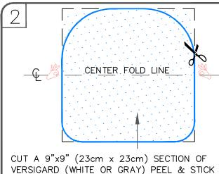
UNCURED FLASHING AND MAKE ROUNDED CORNERS AS SHOWN.
