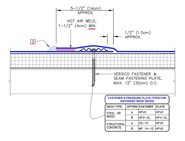
1. POSITION SEAM FASTENING PLATES BEYOND NON-REINFORCED ENCAPSULATED EDGE.
