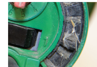
SUCIEDAD Y RESTOS EN LA TOMA DE AIRE
