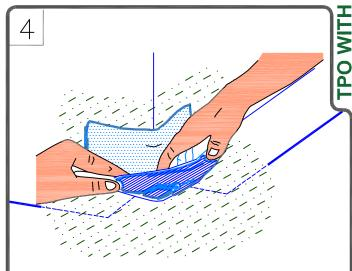
PLACE FOLDED FLASHING TIGHTLY INTO ANGLE CHANGE AND FIRMLY PRESS FLASHING ONTO THE DECK FLANGE BY PRESSING THE FLASHING AGAINST THE HORIZONTAL SURFACE.
