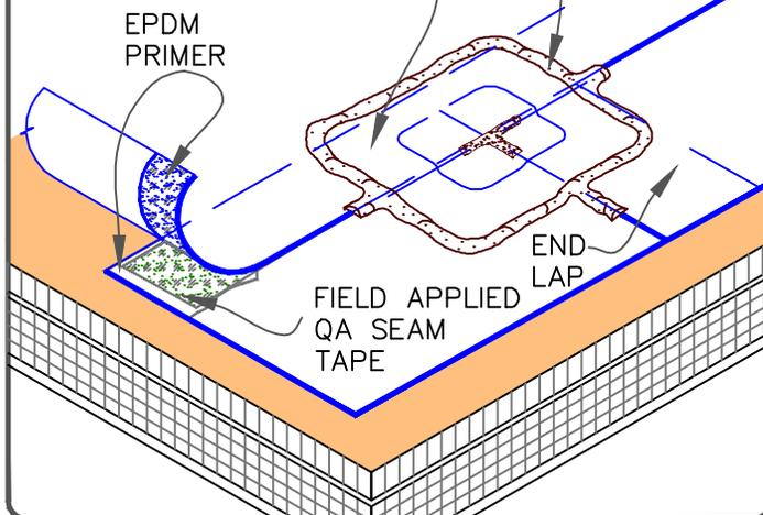
6" (15cm) AND 12" (30cm) QUICK-APPLIED T-JOINT DETAIL PER [VGMA-2.2A](#)
