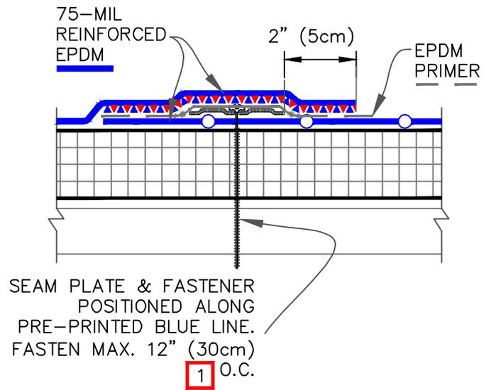
6" (15cm) AND 12" (30cm) QUICK-APPLIED T-JOINT DETAIL PER [VGMA-2.2A](#)
