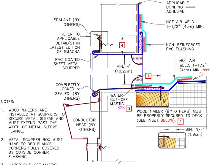
3. WATER CUT-OFF MASTIC UNDER SCUPPER FLANGES MUST BE UNDER CONSTANT COMPRESSION.
