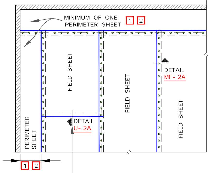
END LAPS DO NOT REQUIRE MECHANICAL FASTENING AND SHALL BE OVERLAPPED 2" (5cm) MINIMUM. PER [DETAIL U-2A](#)
